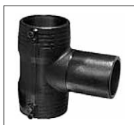
Тройник электросварной 90гр. ПЭ 100, SDR 11; 21
