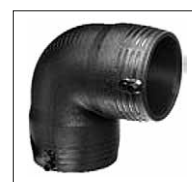
Отвод электросварной 90гр. ПЭ 100, SDR 11
